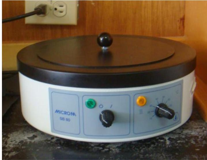
**Figura 9.-** Baño de flotación.
