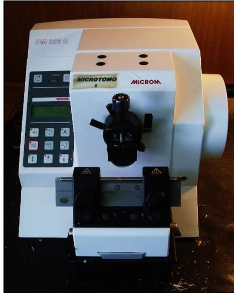
**Figura 8.-** Micrótopo rotatorio electrónico “Microm 355S”, los cortes se llevaron hasta un ancho de 3 micras.
