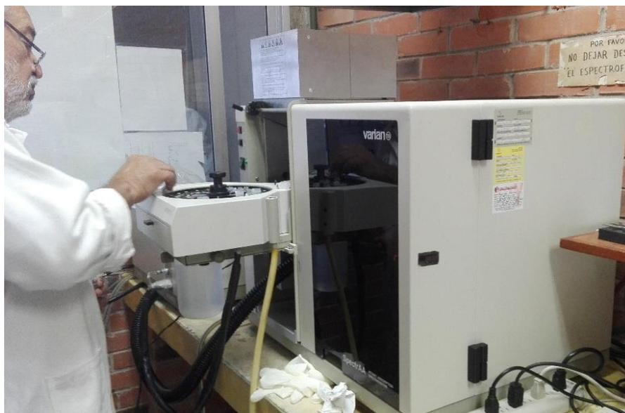
Figura 4. Espectrofotómetro de absorción atómica (Varian SpectrAA 220).
