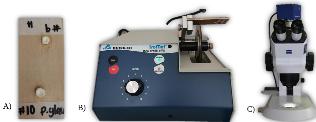
Figura 5. A) Vértebras de Pseudobatos glaucostigmus montadas en madera, B) Cortadora de baja velocidad Isomet (Buehler), C) Microscopio estereoscopio, Zeiss® Modelo Stereo Discovery V12.
