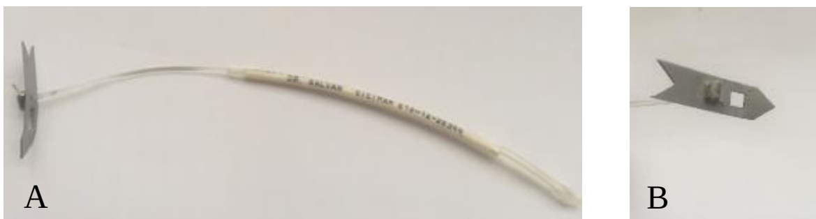
Figura 14. A: Marca convencional tipo espagueti; B: Punta de acero inoxidable de la marca espagueti
