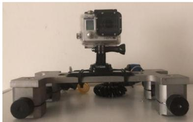
**Figura 5.** Láseres colocados junto a una cámara de video submarina.
