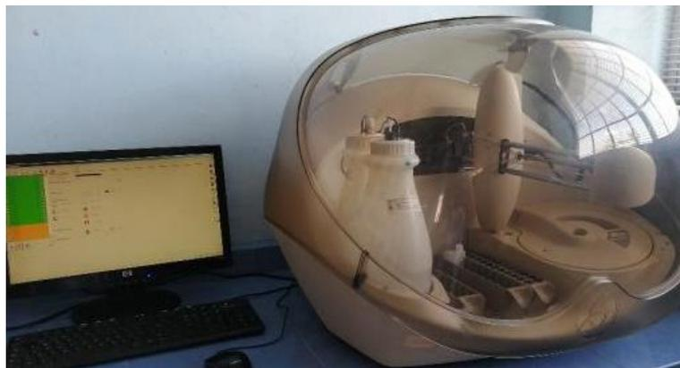
Fig. 9. Analizador automático de lectura fotométrica A15 de *BioSystems*®, capaz de leer absorbancias de hasta 3  $\mu$ L de muestra
