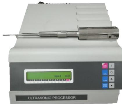
*Fig. 5. Sonicator empleado para extraer compuestos celulares, CVX 130 PB, Vibracell®*
