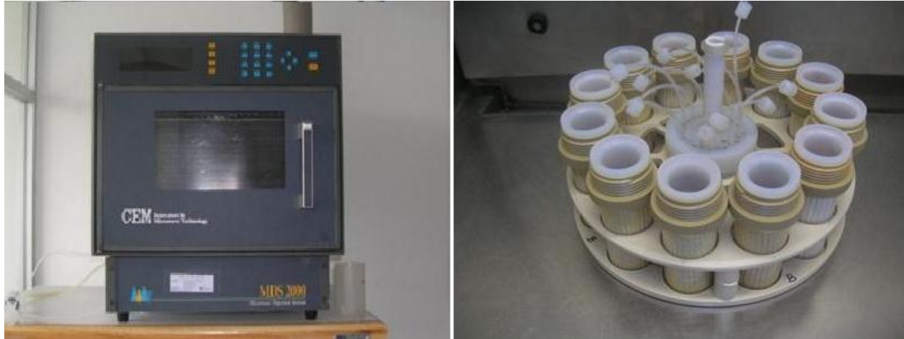
Fig. 4. Digestor electromagnético en sistema cerrado con sus respectivos vasos.
