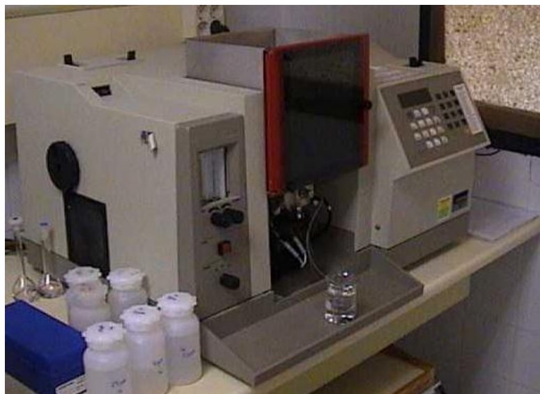
Fig. 5. Espectrofotómetro de absorción atómica por generación de hidruros.
